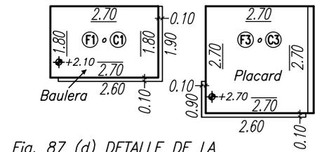
Fig. 87 (d) DETALLE DE LA BAULERA Y DEL PLACARD
