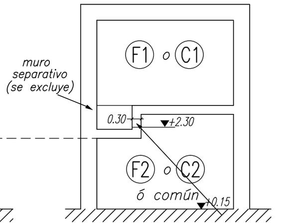
muro común superpuesto (se excluye de la poligonal y se proyecta)
